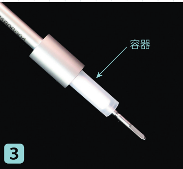
AFを容器ごとガイドピンに通し、青いキャップを外す。その際、AFが落下しないように注意しながら行う。
